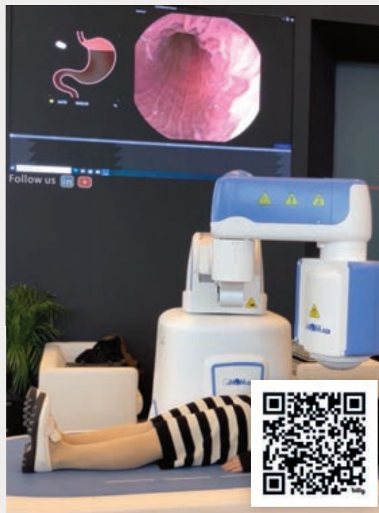
Figure 1. Vidéo du guidage magnétique d'une vidéocapsule endoscopique de l'estomac lors d'une démonstration chez une volontaire saine.
